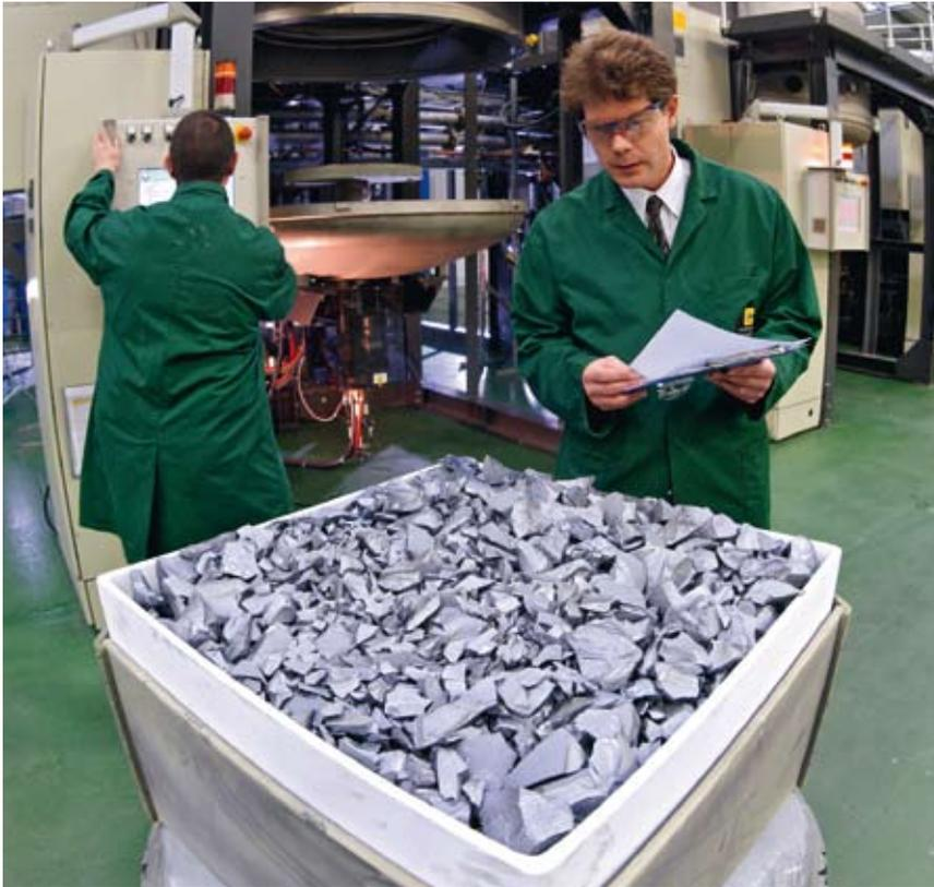
Rohsilizium ist ein sprödes Halbmetall mit einer Reinheit von 99 Prozent.
